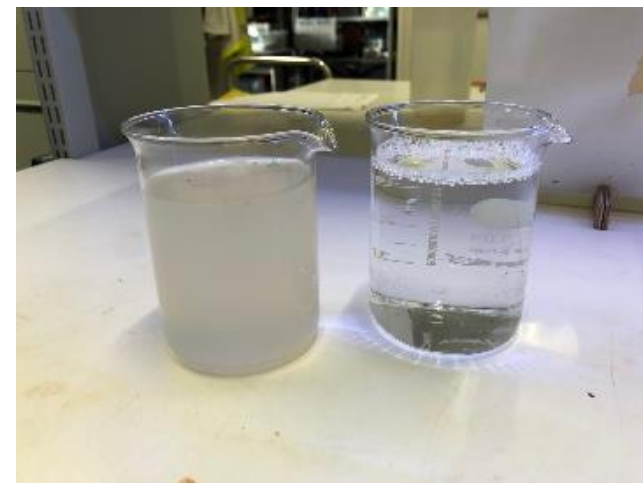
Kalajalostamotehtaan jätevesinäyte vasemmalla sekä kalvomembraanireaktorilla käsitelty näyte
